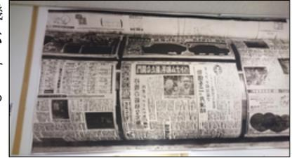
昔の新聞は、活字を活字棚から拾ってケースに組み上げていき、そこでステロ版という紙型を作り、それで大量の紙に印刷していく方法を取っていました。この活字を作るには、鉛が約80%、アンチモンが約15%、錫が約5%で合金の地金を作って母型に流し込み作製していたようです。
